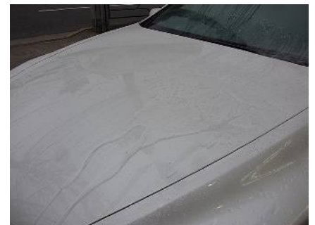
★各パネル毎・ボンネットは半分ずつ作業してください。塗り残しにご注意下さい。
